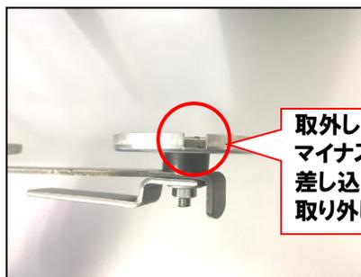
取外し難い場合は差込穴にマイナスドライバー等を差し込んでテコの原理で取り外して下さい。
