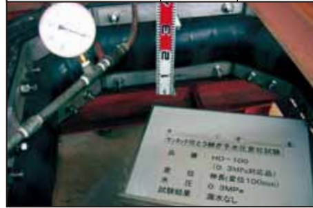
水圧試験状況 (HO-100 : 高水圧タイプ)
